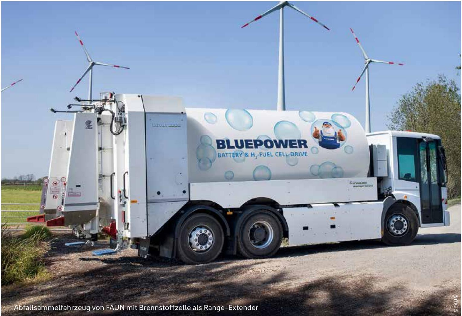
Abfallsammelfahrzeug von FAUN mit Brennstoffzelle als Range-Extender
